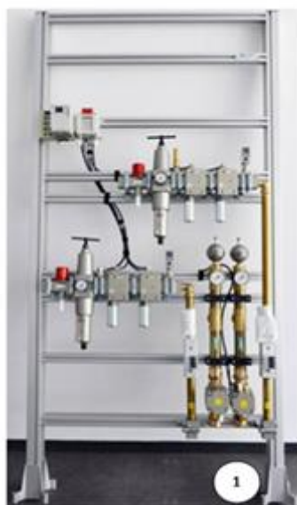
Rys. 6. Przykładowe układy przygotowania mediów: 1 – centralny.
