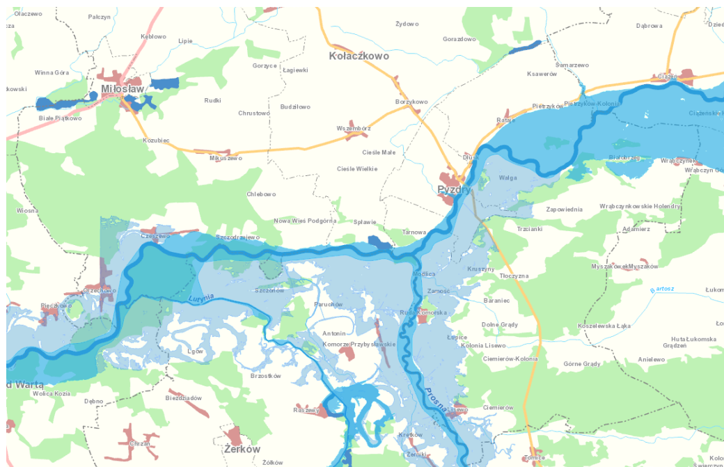
Ryc. 12. Obszar zagrożenia powodziowego dla prawdopodobieństwa Q=2\% (niskiego) oraz obszar powodzi dla scenariusza zniszczenia lub uszkodzenia wału powodziowego na terenie powiatu wrzesińskiego
